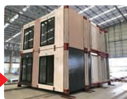
仮組み 製造完了
