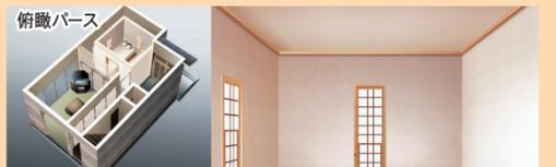
※1『一条工務店の耐震シェルター』既存の住まいに手を加えることなく、工期もわずか2日間設置できる耐震シェルター。大きさは、内部にシングルベッドが2台設置できる広さを確保し、常時居住にも違和感のないクロス貼り仕上げ。出入口は、建具を取り付けると震災時に瓦礫で塞がれて開閉できなくなるため、枠のみの施工。販売価格は、なるべく多くの「人命を守る」ことに貢献したいという思いから、施工費を含め25万円(税抜)。※別途床補強工事が必要となる場合もあります。※3tトラックが侵入できない場合や室内に壁パネルが搬入できない場合は設置できません。
